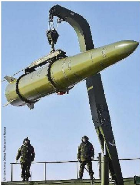
RAZZO IPERSONICO Un missile Iskander usato dai russi. Vola a quasi 6 volte la velocità del suono e ha una gittata di circa 400 km.
